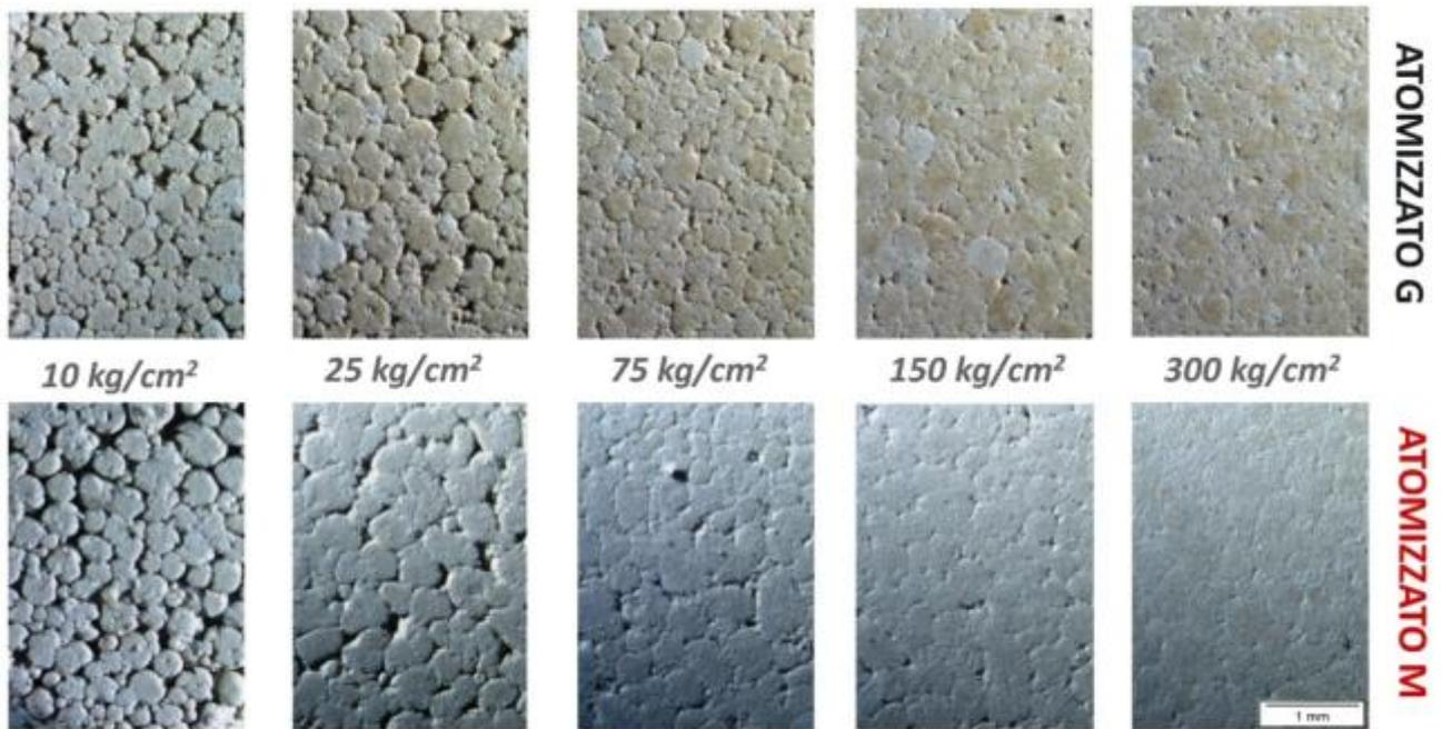
Fig. 1 - Immagini al microscopio di due diversi atomizzati, sottoposti a differenti pressioni di pressatura. Si osserva come, all'aumentare della pressione, aumenti la coesione tra i granuli di atomizzato.
