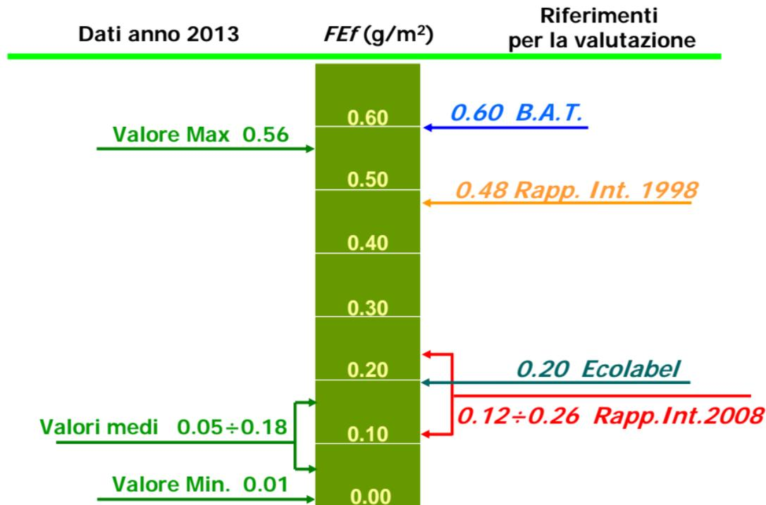
Figura 2 - Emissioni in atmosfera: composti del fluoro.
